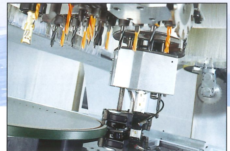
Erstklassige Ergebnisse - für bestechende Kantentoptik sorgt das getastete Kombi-Bündigfräs-Nachputzaggregat, das den Antrieb, die C-Achse sowie die Pneumatik verwendet. Auch hier handelt es sich um patentierte HOMAG Technik
