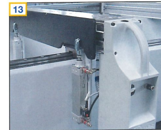
13 Robuste Einlegehilfen zur Auflage schwerer Werkstücke
