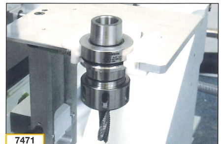
Werkzeugübergabeplatz, sicheres und schnelles Beschicken des Werkzeugwechslers inkl. Leerplatzabfrage im Werkzeugwechsler
