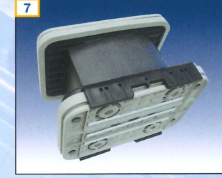
7 Vakuumsauger mit speziellem Kamersystem (Patent der HOMAG Gruppe) zur freien Positionierung auf den Konsolen (16/20 Standard- und 8/10 Schmalteilsauger)
