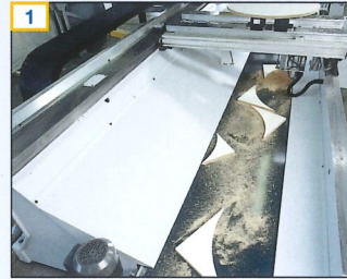
1 Arbeitsfeld von X = 4.175 mm (12L) bzw. 6.175 mm (12XL) und Y = 1.730 mm mit optimaler Reststückentsorgung durch das „offene“ Maschinenbett (optional mit Spänetransportband)
