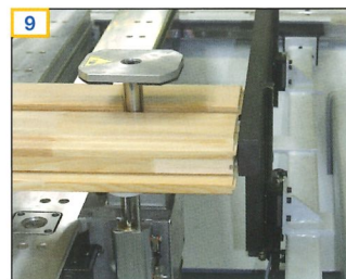
9 Anschlaglineale zur exakten Positionierung der Werkstücke in X-Richtung, unabhängig von der Teilezahl oder Teilebreite
