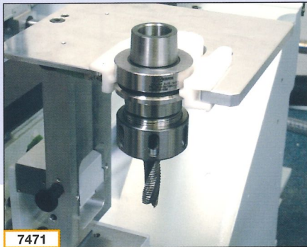
7471 Werkzeugübergabeplatz, sicheres und schnelles Beschießen des Werkzeugwechslers inkl. Leerplatzabfrage im Werkzeugwechsler
