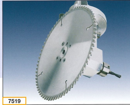
7519 Säge-/Bohraggregat 2 Spindel: zum Nuten, Bohren und Sägen (auch für Gehrungsschnitte). Als Säge-/Kappaggregat (7513) mit Schnitttiefe bis 110 mm
