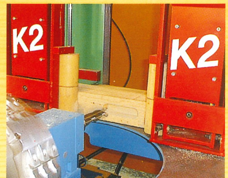
Zapfen und Zapfenlöcher werden rund gefräst. Vorteil: exakt und schnell
