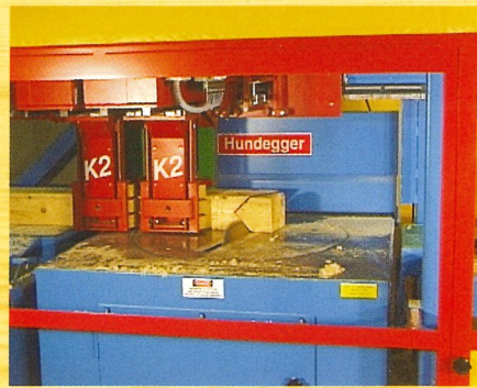
Hexenschnitte mit beliebigen Schnittwinkeln und Schnitttiefen
