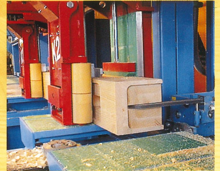
Schlitzte können auch verdeckt hergestellt werden
