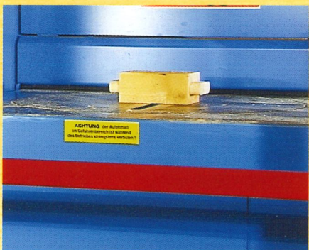
Kurze Hölzer ab 30 cm können automatisch bearbeitet werden
