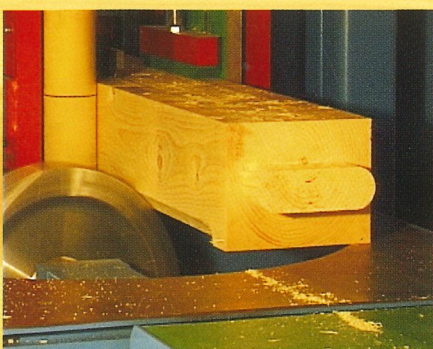
Fasen auf allen 4 Bauteilseiten
