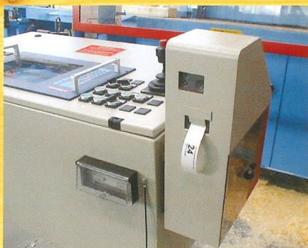
Pulldrucker für Etiketten mit der Angabe von Bauteilname, Bauteilnummer usw.
