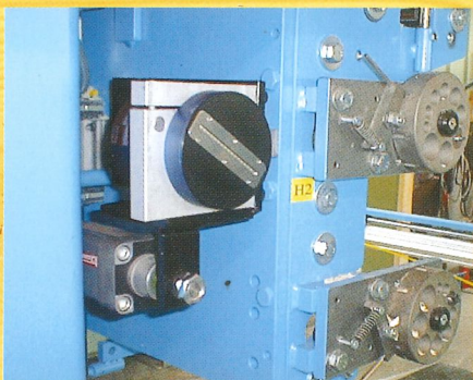
Tinten-Beschriftungssystem für Beschriftungen von 13 bis 45 mm Höhe
