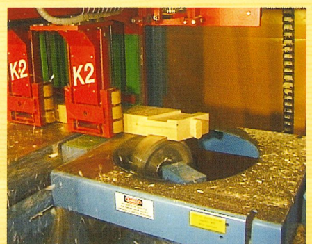
Ausblattungen in jedem Winkel auf allen 4 Bauteilseiten
