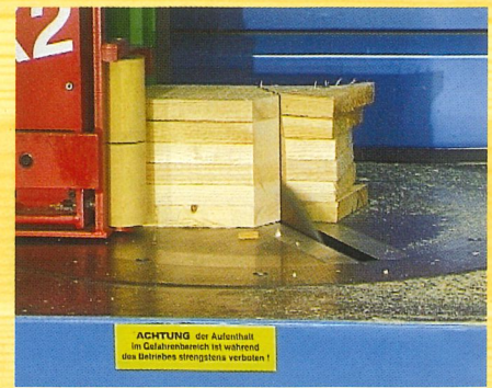
Mehrlagiger Zuschnitt für Ständer oder Nagelplattenbinder
