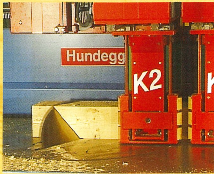
Jede Art von Schifterschnitten
