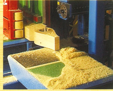
Bohrungen verschiedenster Größe wie auch Sacklochbohrungen
