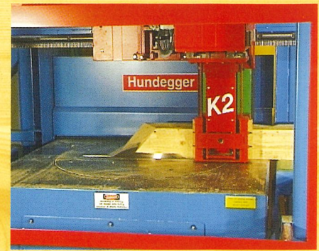
Auskehlungen oder Abgratungen vollautomatisch und millimetergenau
