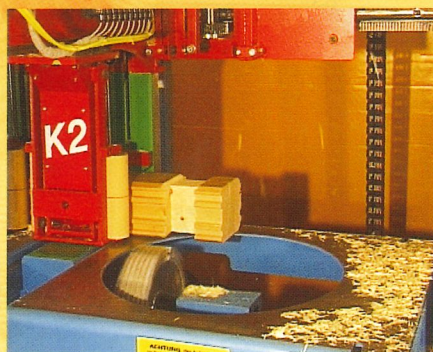
Verschiedene Blockhauseckverbindungen sind als Holzknotenpunkte hinterlegt
