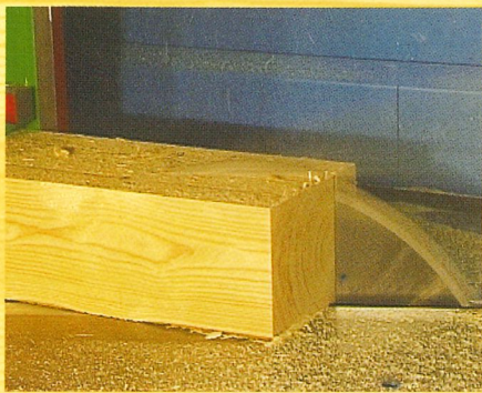
Verjüngungsschnitte in beliebiger Länge und Winkel
