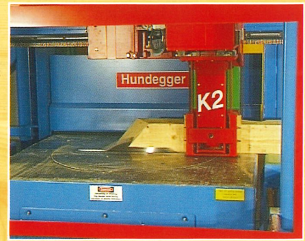
Scanalature opure sbavature pienamente in automatico e con precisione millimetrica
