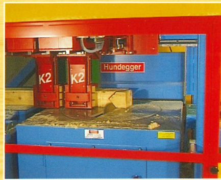
Tagli delle travi di compluvio/displuvio con diversi angoli e profondità di taglio
