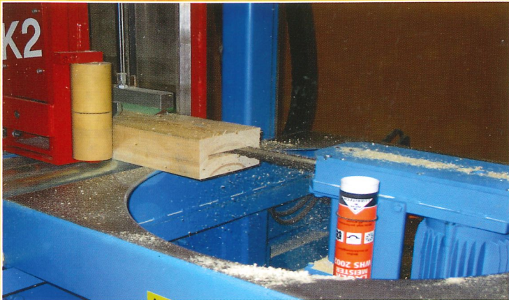
Intagli nascosti o angolari adesso sono relizzabili con il nuovo attrezzo per intagli orientabile.
