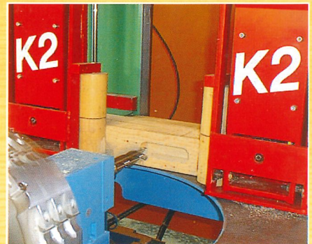
Incastri e fori per incastri vengono fresati tondeggianti. Vantaggi : precisione e rapidità
