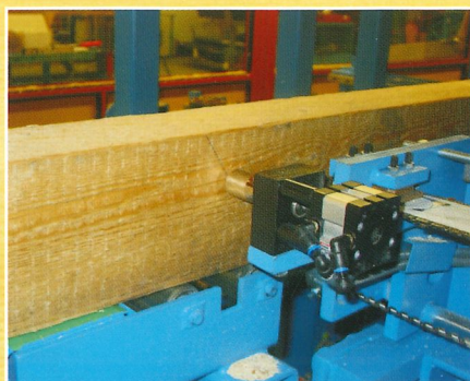
Con il marcatore si possono eseguire scritture e marcature trasversali.
