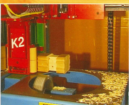
Diversi collegamenti per case in blocco sono depositati come giunti di legno
