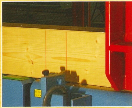
Travi tracciate su tutti i 4 lati
