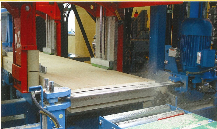
Con l'attrezzo per intagli guidato si possono lavorare precisamente e rapido fessure fino ad una larghezza del legno di 625 mm e fessure nascoste sulla parte d'affisso.
