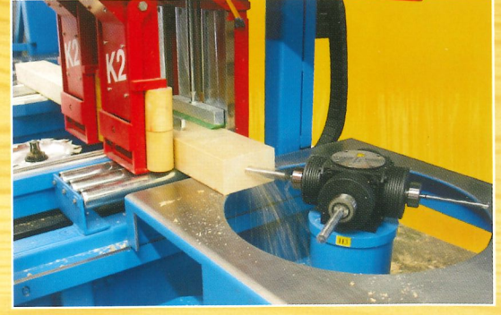
Fraise Revolver. Montage jusqu'à 5 outils, comme perceuse, défonceuse, fraise universelle ou fraise à queue d'aronde.
