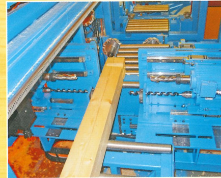
Avec le double support horizontal on pourra effectuer tous types de perçages et fraisages sans éclats, simultanément sur deux faces. Le temps de cycle est raccourci très sensiblement.
