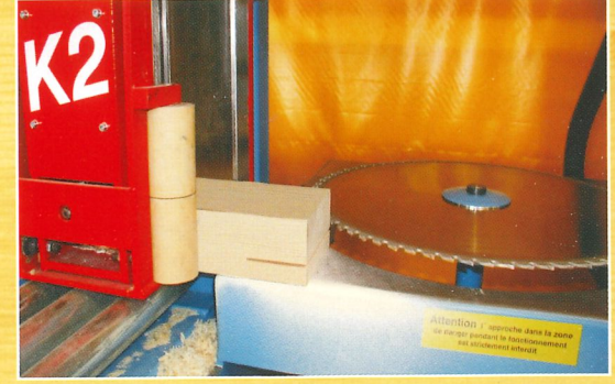
La scie horizontale permet d'autre part de réaliser rapidement et proprement des fentes d'une profondeur maximum de 300 mm.
