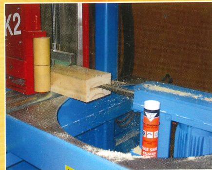
Notre nouvel appareil pivotant pour fentes en chaînette vous permettra par exemple d'usiner facilement des fentes masquées ou en angle.
