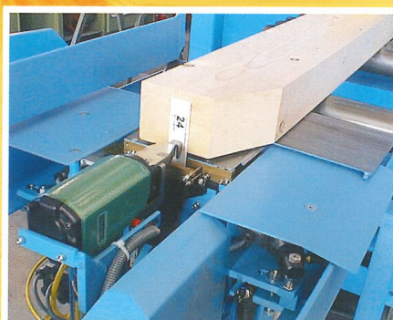
Système entièrement automatique d'étiquetage des éléments de construction
