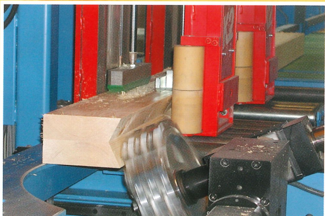
La nouvelle fraiseuse à 5 axes pour la K2 présente de nombreux autres avantages tels que des cannelures ou des bavures sans résidu de bois
