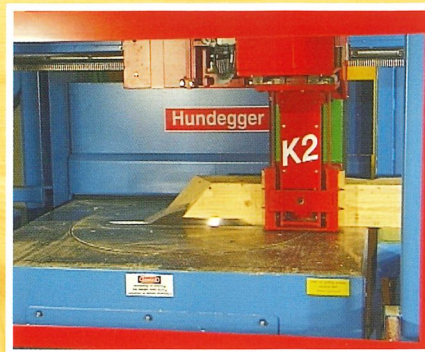
Cannelures ou coupes de noue entièrement automatiques, au millimètre près
