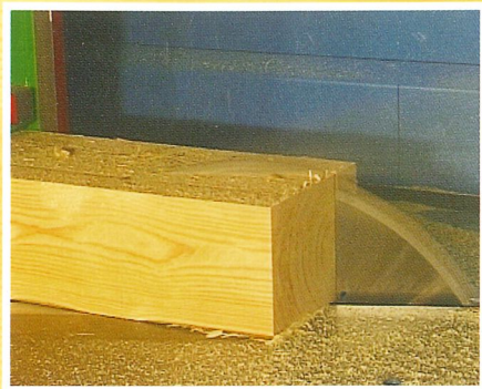
Coupes en cône à longueur et angle à discrétion
