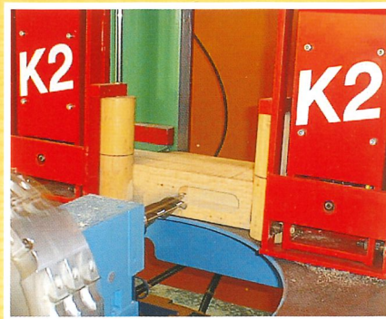
Les tenons et mortaises sont mortaisés en arrondi. Avantage: précision et rapidité
