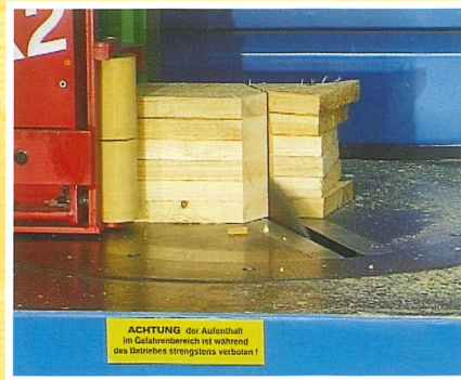
Coupe multi-couches pour montants ou fermes clouées
