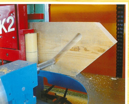
Limon d'escalier, réalisé par la fraise universelle
