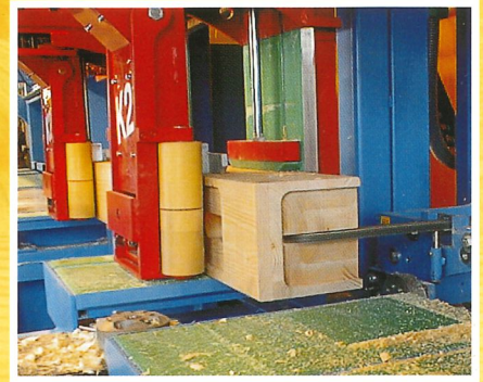
Possibilité de réaliser des entailles masquées
