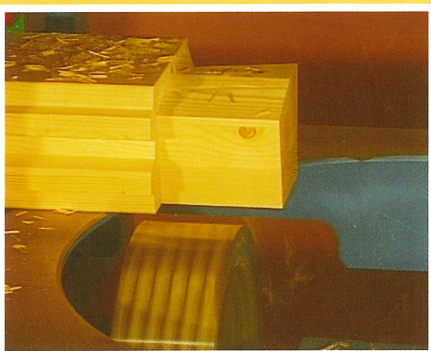
Le bois profilé est transporté sans endommagement pour être usiné
