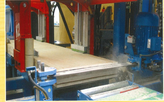
Cet appareil permet en effet d'effectuer rapidement et précisément des fentes masquées sur la surface d'arrêt ainsi que des fentes d'une longueur quelconque sur des pièces d'une largeur maximale de 625 mm.
