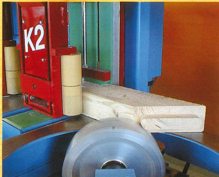
Assemblages à mortaise et tenons de toute sorte et de dimensions à discrétion
