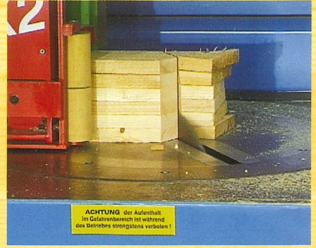
Coupe multi-couches pour montants ou fermes clouées
