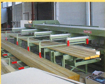
Empilage automatique des paquets
