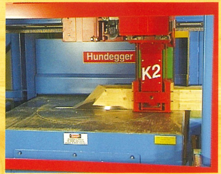
Cannelures ou ébarbages entièrement automatiques, au millimètre près
