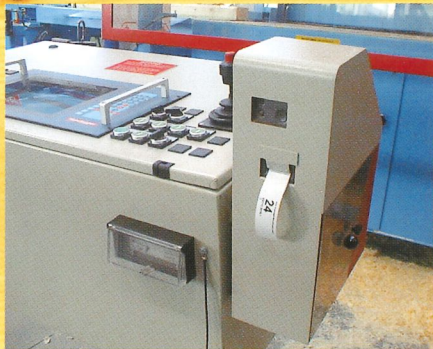
Imprimante d'étiquettes sur pupitre indiquant la dénomination de l'élément de construction, le numéro de l'élément de construction etc.
