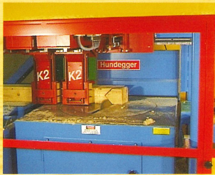
Coupe à angles et profondeur de coupe à volonté
