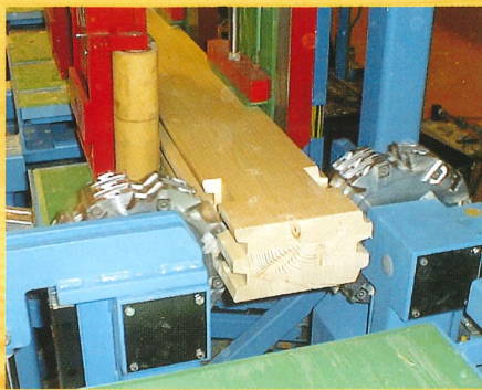
Fraise pour maisons en bois ronds - usinage vertical
