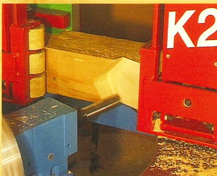
Encoches en forme de cœur avec ou sans dégagement
