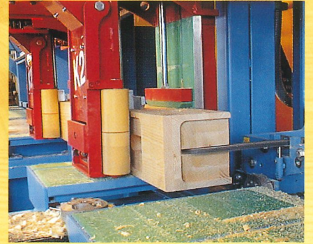
Possibilité de réaliser des entailles masquées
