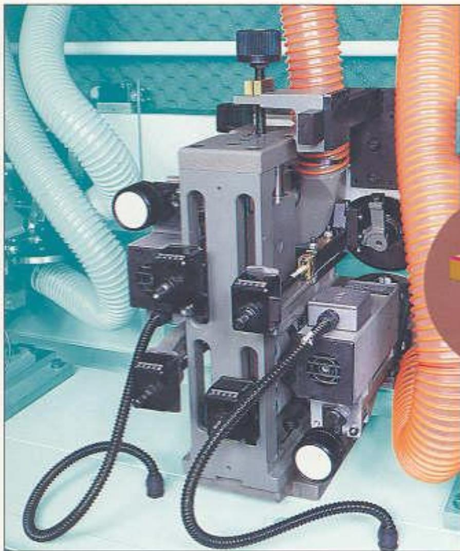
**FUNKTION** Abnahme durch Befräsung (Feinfräsen) der oben/unten überstehenden aufgleimten Kante.
