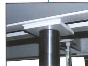
Supporto superiore cilindri libero Cylinder thrust plates obere Zylinderauflageplatte schwimmend befestigt
