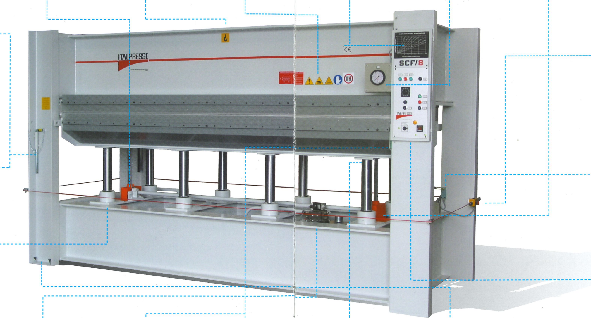
Fune più interruttore di sicurezza Perimeter E-stop System Sicherheits-Reißleine mit schalter
