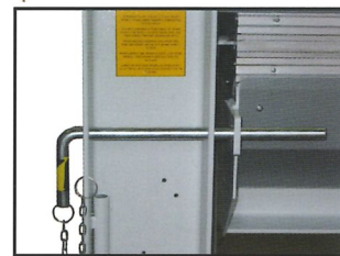
Chiavistello per bloccaggio piani in fase di manutenzione Safety lock Verriegelungsbolzen für die Heizplatte bei Wartungsarbeiten
