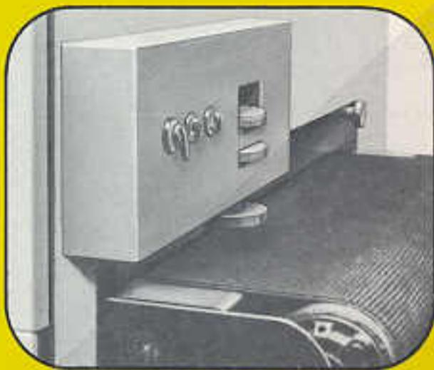
Beim Feinschliff wird eine Spezial-Luftfederung wirksam, mit der sich jede Schleifstation selbsttätig auf das gerade durchlaufende Werkstück einstellt und deren Dickenunterschiede ausgleicht. Dadurch können pro Zeiteinheit mehr Werkstücke bearbeitet werden.
