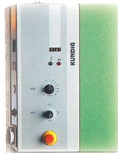
Elektronische stufenlose Vorschubregelung
