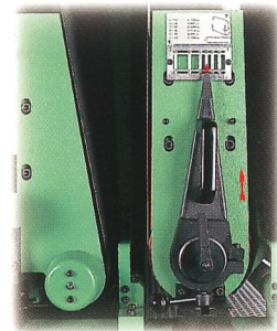
Höhenverstellbare Kontaktwalze mit Kornskala
