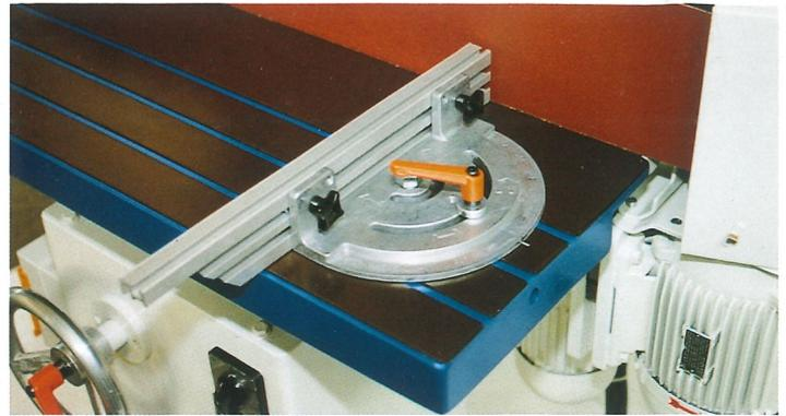
Gehrungsanschlag mit stufenloser Winkeleinstellung und verschiebbarem Lineal.
