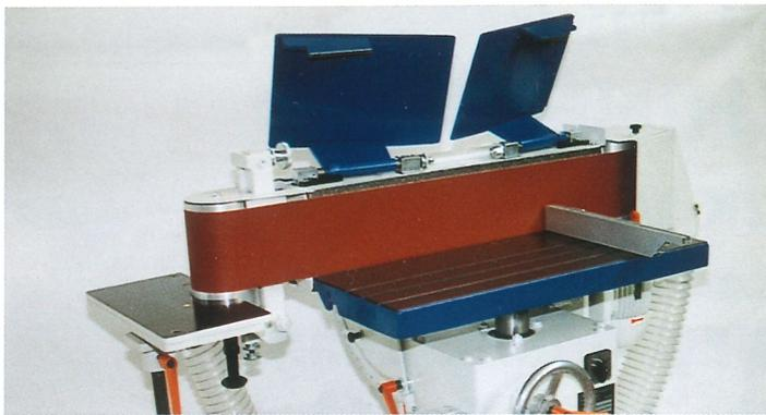
Durch das Hochklappen der Lineale wird aus der Furnierkantenschleifmaschine eine **MASSIVHOLZSCHLEIFMASCHINE**.
