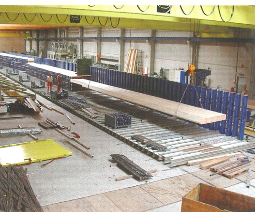
HYPERPRESS SPS gesteuerte Bogenpresse Diese Presse wurde zur automatisierten Herstellung von gekrümmten Bauteilen aus Brettschichtholz entwickelt. NC press for curved beams. We have managed, through numerous innovations, to develop the PLC curved beams press that satisfies the demands of the present time.
