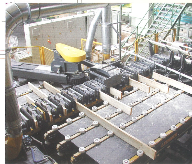
Durchlaufkeilzinkenfräs- und Beilemmaschine für BSH-Anlagen. Finger jointing continuous milling and gluing machine for laminated beam plants.
