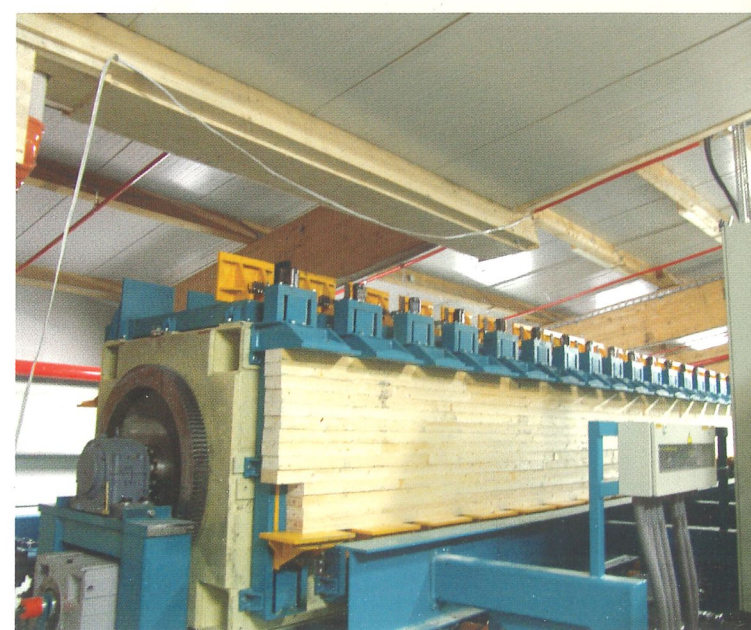
Die Rotopress Anlage ist zur vollautomatischen Verpressung von Duo- und Triobalken, Brettschichtholz, Blockhauselementen, Fensterkanteln, Schalungsträgern, Deckenelementen und Deckenbalken geeignet.
