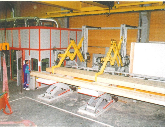
Hobelanlage für Brettschichtholz bis 1.100 mm Arbeitsbreite. Laminated beams plant with working width of up to 1.100 mm.
