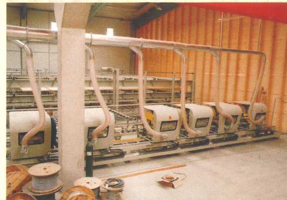
Aushärtet Förderer und Mehrfachablängsäge. Glue-drying conveyor and multiple cross-cutting saw.
