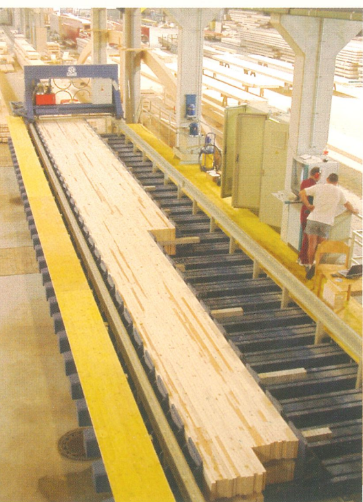
FLEXIPRESS Liegendes Pressbett für BSH. Diese Presse ist zur flexiblen Herstellung von geraden Bauteilen aus Brettschichtholz geeignet. Horizontal press for glulam beams This press is suitable for the flexible production of straight laminated beams.
