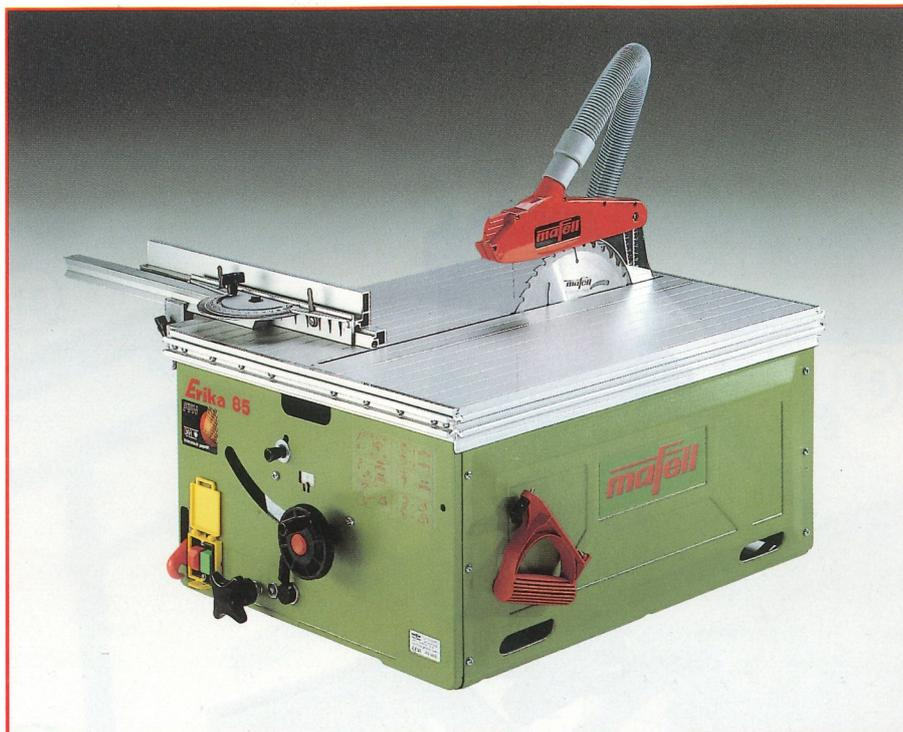
Die ERIKA 85 ist sekundenschnell von der Unterflur-Zugsäge zur Tischkreissäge umgebaut. Über den direkten und synchronen Antrieb beider Verstell-Wiegen ist eine Schrägstellung des Sägeblattes von -3 bis 48° möglich. Wichtig zum
