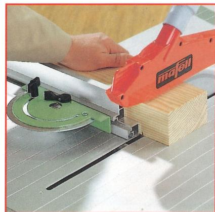
**Fugenloser Stoß durch Hinterschneiden.** Das Sägeblatt der ERIKA läßt sich nach einer genauen Winkelskala in den kleinsten
