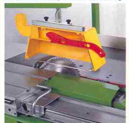
Parallelogrammschutzhaube breit für Gehrungsschnitte. Vorritzsägeaggregat.
