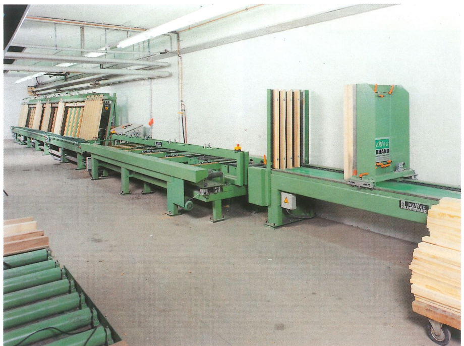
Verleimanlage mit Magazin und Leim-Gießmaschine
