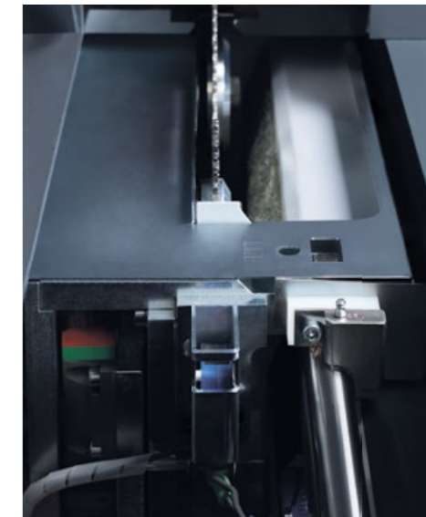
Sofisticate guide senza usura per il carro sega danno con ogni taglio l'esatto angolo di 90° anche dopo anni di uso continuo industriale.
