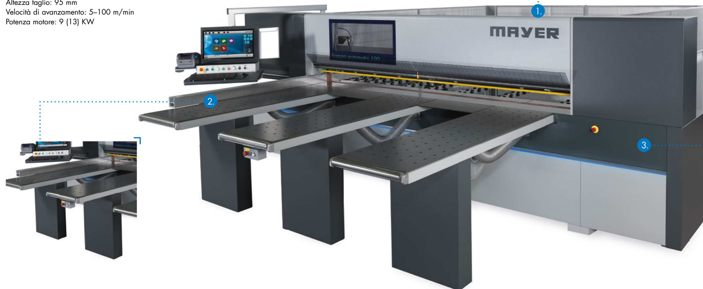
La massiccia guida ad angolo in acciaio garantisce squadrature assolutamente perfette.
