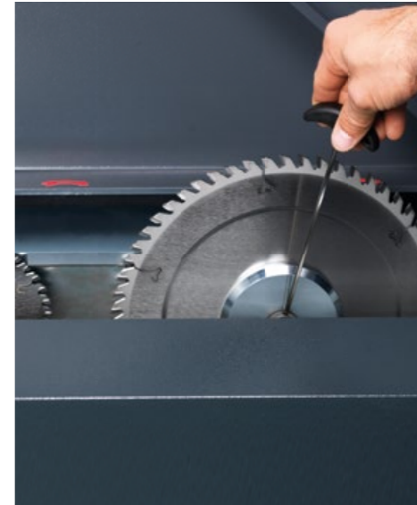
Il cambio lama rapido ProLock® EasyFix garantisce i minori tempi di attrezzaggio.
