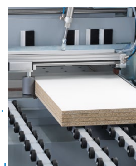
Pressore a d'angolo per un' allineamento delicato e preciso dei pannelli.
