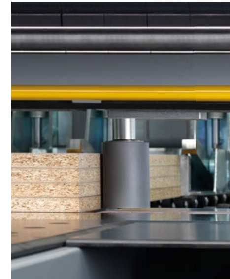
Doppio pressore ad angolo – posizionamento di precisione senza compromessi sulla guida angolare.
