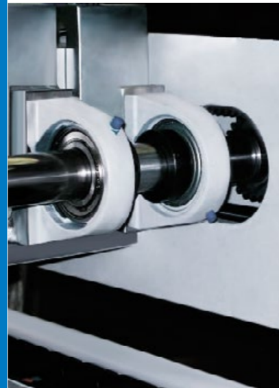
Spintore con servomotore AC con sistema di misurazione indipendente per la miglior precisione negli utilizzi più duri.
