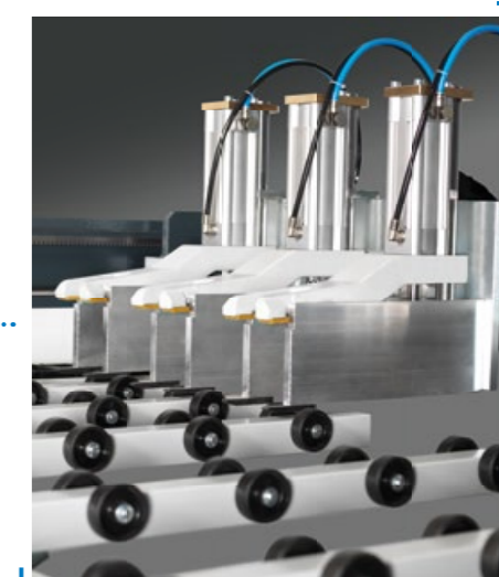
Pinze in versione Doppelfinger con regolazione variabile della pressione.
