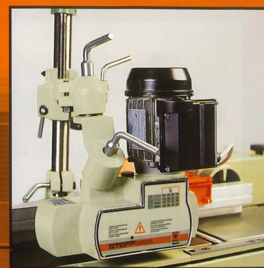
▲ Positionierung auf Abriethobelmaschine
