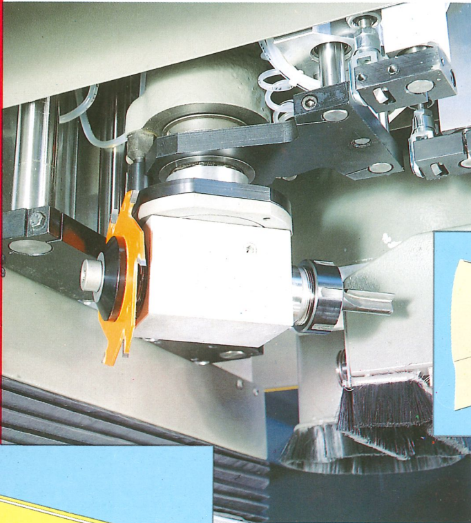
360° Horizontalwinkelgetriebe mit Aufnahme für Nutsäge und Schafffräser.
