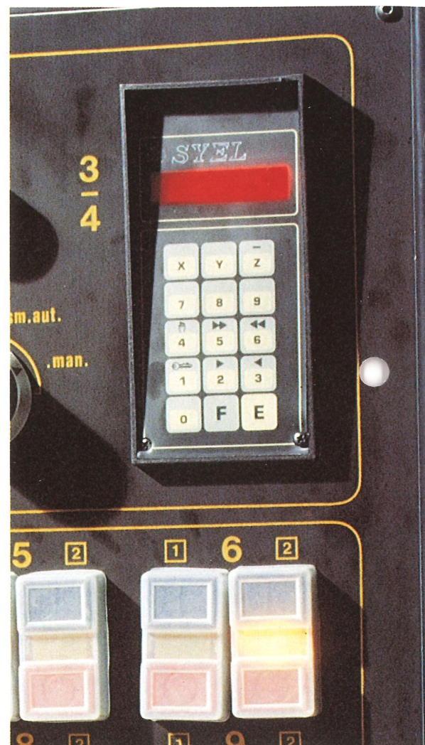
Elektronische Positionierung der Endanschläge
