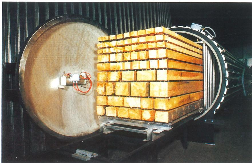
*In der eigentlichen Trocknungsphase wird der Dampf aus dem VAKUUMTROCKNER abgesaugt und in einer Wärmerückgewinnung entfeuchtet. Die dabei freiwerdende Wärmeenergie können Sie vollständig zu weiteren Heizungszwecken nutzen. In dieser rückgewonnenen Wärmeenergie ist die gesamte, in den VAKUUMTROCKNER geschickte Energie enthalten.*
