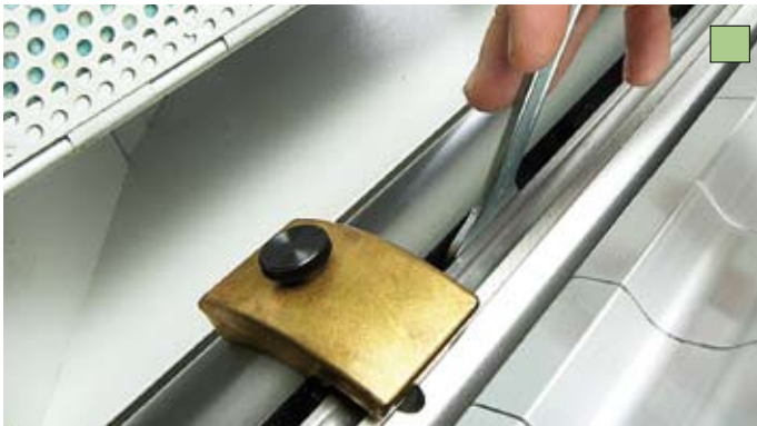
Panhans-Viermesserwelle mit Streifenhobelmesser und zwei aufschraubbaren Messing-Einstellgeräten
