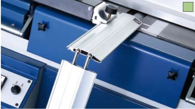
Hobelschutzvorrichtung Typ 1570 TXF 850 mit zweiteiliger Abdeckung stufenlos in der Höhe verstellbar
