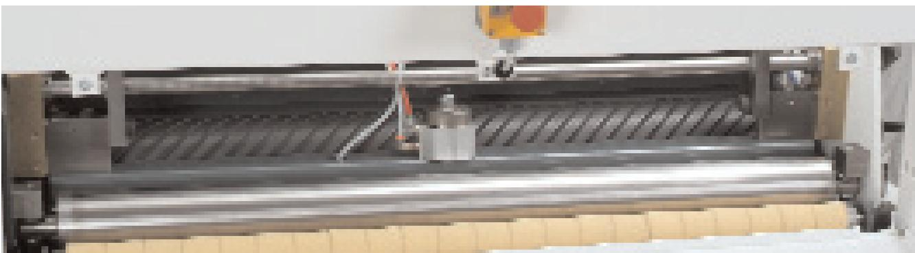
**I 13 Tampone pneumatico ad intervento a tempo sincronizzato con la velocità del tappeto.**
