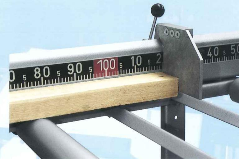
Abb.16: Pneumatischer Anschlag
