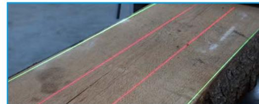
Fig. 3 : Laser à lignes pour l'alignement des pièces ciblé.
