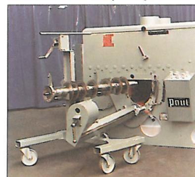
Abb. 16: Wellen-Einführwagen
