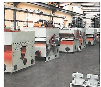
Abb. 8: Montage der Mehrblattsägen
