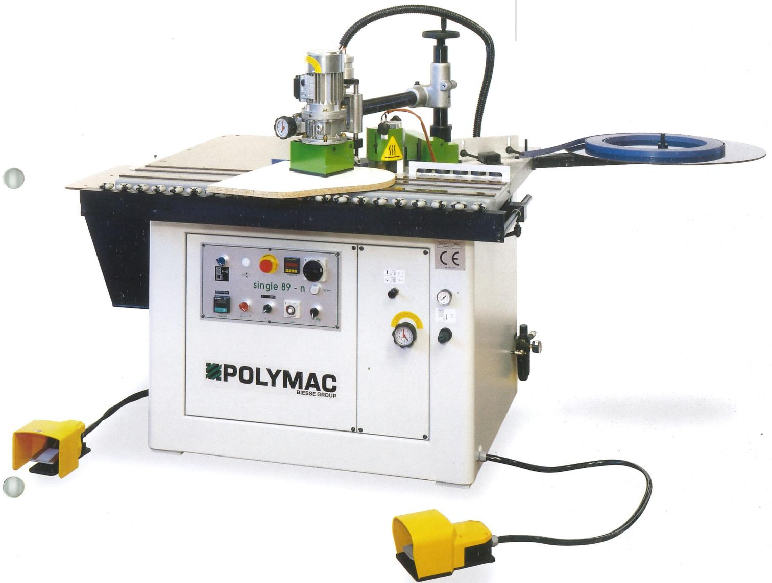
La Single 89 è una macchina estremamente flessibile per l'applicazione di bordi plastici e legnosi, fino a 3 mm di spessore.
