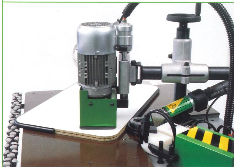
Máquina semiautomática para la aplicación de cantos de goma con sección en "T", en paneles de diferentes formas y dimensiones, sin la ayuda de contraplantillas.
