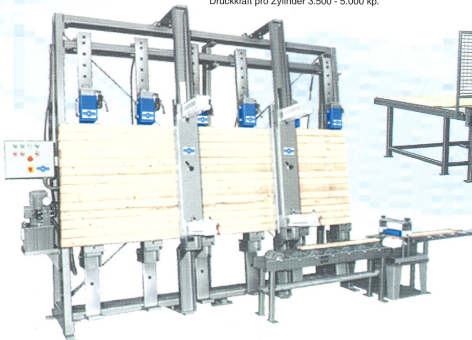
Elektro-Hydraulik-Kompakt-Block- und Lamellierpresse, Druckkraft pro Zylinder 3.500 - 5.000 kp.
