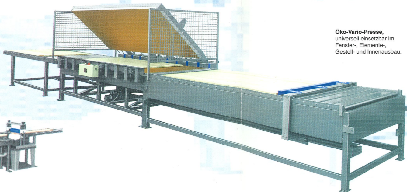
Beheizte Etagen-Verleimstation mit Ein- und Ausschubvorrichtung.
