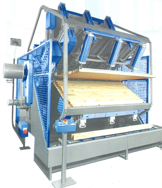
Elektrisch beheizte Pneumatik-Etagen-Verleimanlage mit 4 oder 6 Verleimetagen.
