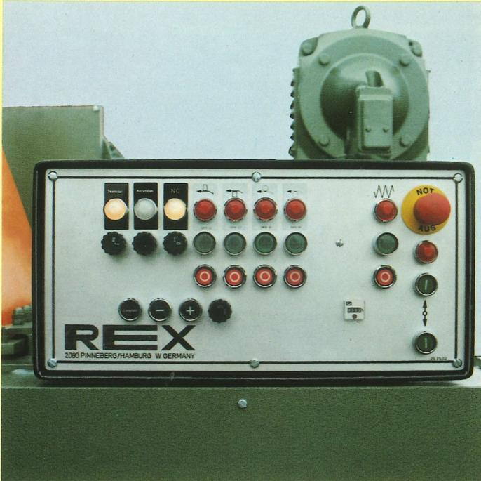
Abb. 30 Bedienungspult für E-Funktionen
