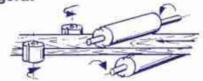
**A+D+FR+FL+HFR+AZG = 4-Seiten Hobelmaschine mit Auszugsgerät und 5ter Welle**
