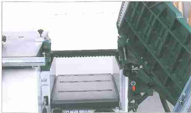
S Odklopné stoly tloušťkovací frézky · Swing-away tables of thicknesser Aufklappbare Tische der Dickenhobelmaschine Mesas desplazables de la regruesadora · Tables rabattables de la raboteuse Верхнее положение стола рейсмуса
