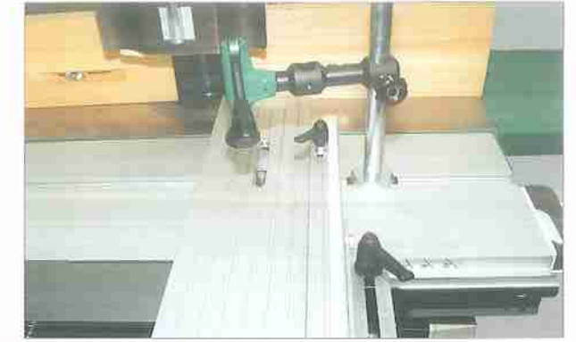
O Zařízení pro čepování krátkých kusů · Tenoning plate for short workpieces Zapfenschneideinrichtung · Equipo para fresar piezas cortas Plaque de tenonage · Оборудование для шипования коротких заготовок
