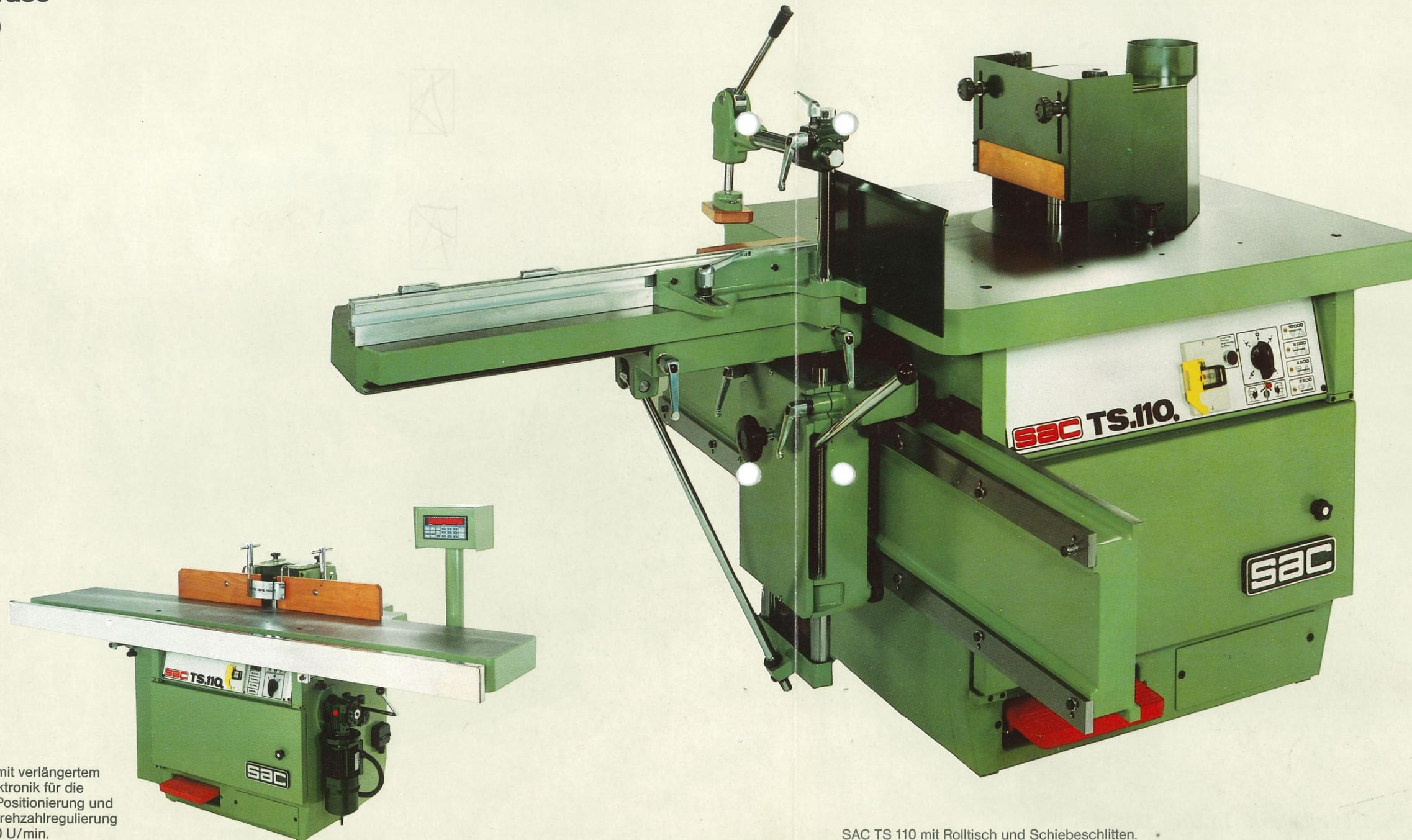
SAC TS 110 mit verlängertem Tisch mit Elektronik für die Frässpindel-Positionierung und stufenloser Drehzahlregulierung von 0 - 10.000 U/min.
