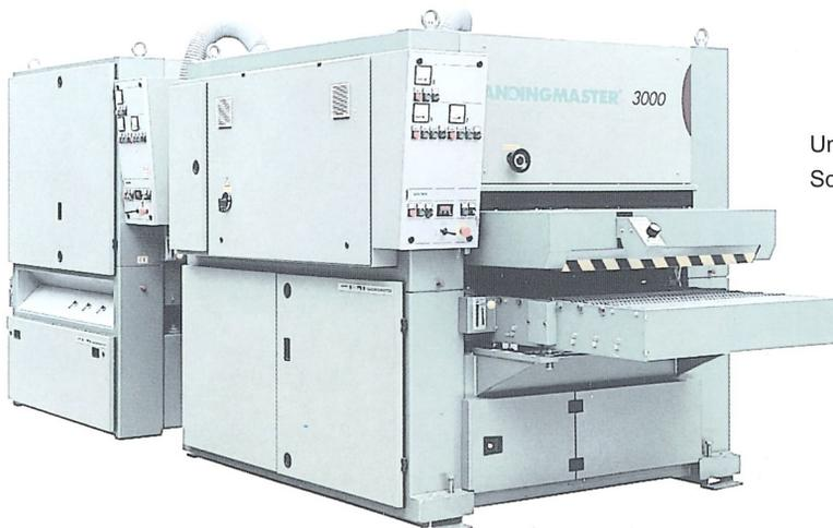
Untenschleifer mit schräggestellten Schleifaggregaten, Schleifbandlängen: 1900, 2150 und 2620 mm
