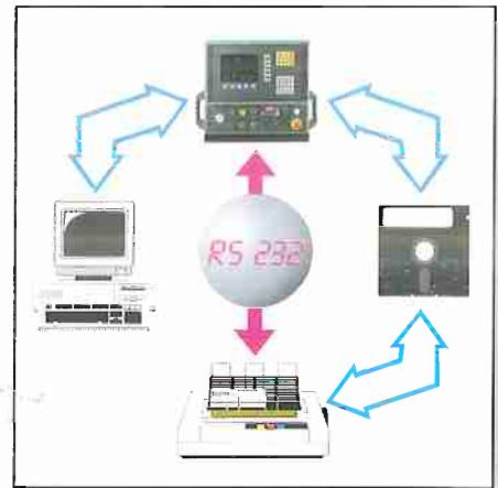
L'OPERATOR è stato concepito come sistema aperto, con capacità di dialogo con unità esterne presenti in un'azienda moderna ed efficiente. L'interfaccia seriale RS 232, di cui è dotato il centro, permette lo scambio di informazioni con un personal computer, per trasmettere direttamente distinte di produzione: forma, dimensioni, quantità dei pezzi e tipo di infisso, oltre al posizionamento automatico a controllo numerico della sega per intestatura e della battuta legno.
