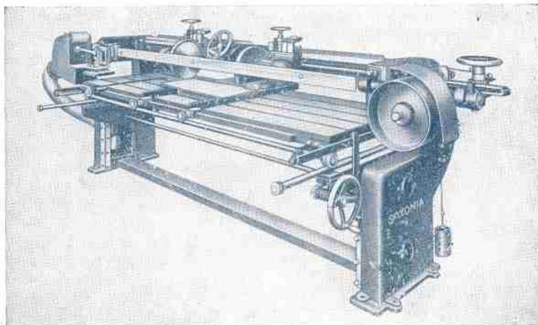
Bandschleifmaschine, kombiniert mit doppelter Abkürzkreissäge
