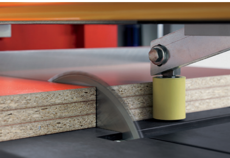
Kraftvolles Sägeaggregat mit 14 kW Leistung
