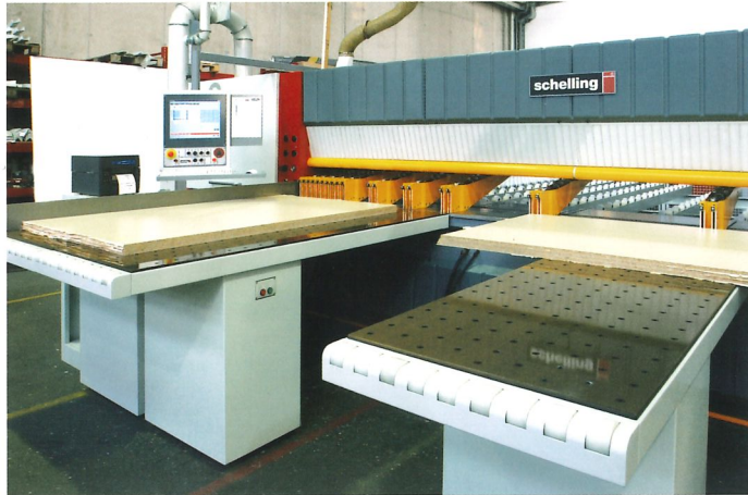
Luftkissentisch - verfahrbar für individuelle Anwendungen
