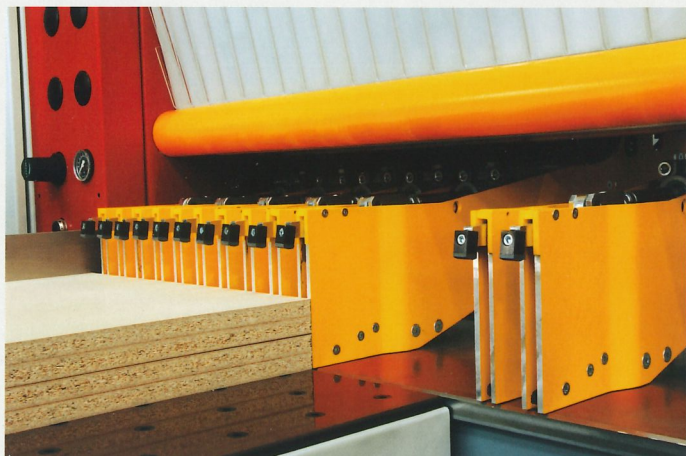
Scherenklemmer - Ausschieben auf die Luftkissentische
