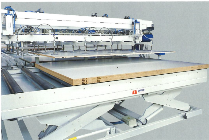
Alimentare cu sistem cu vacuum - transportul plăcilor sensibile
