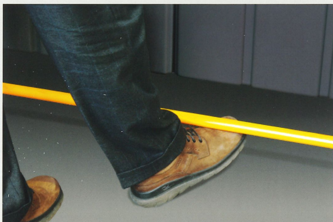
Sistem cu pedală pentru pornire/oprire - împingere la mesele pe perne de aer
