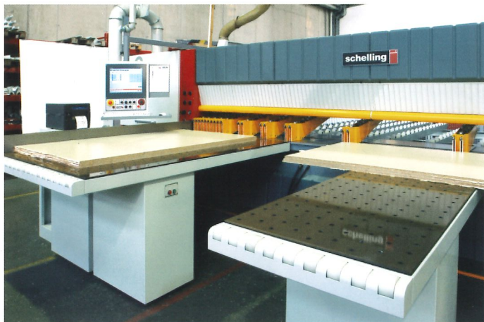
Masă pe perne de aer - mobilitate pentru aplicații individuale
