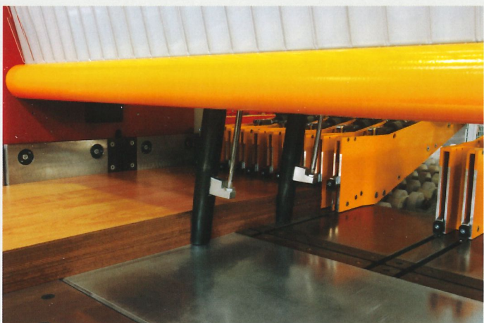
Dispozitiv dublu de aliniere - precizie unghiulară maximă
