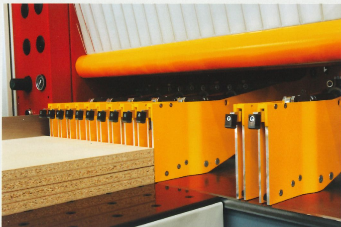
Dispozitiv de strângere în foarfece - împingere la mesele pe perne de aer
