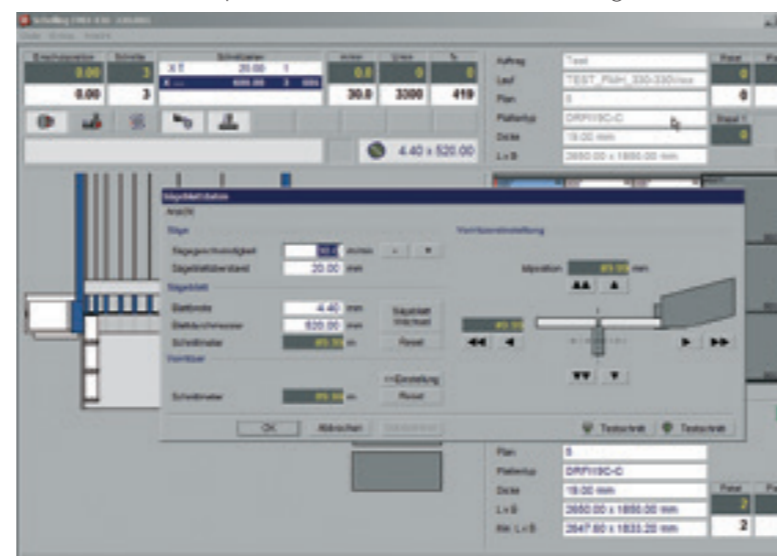
Bedienpult: elektronische Vorritzereinstellung
