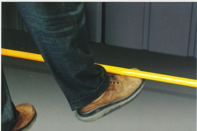
Nožná lišta pre Štart/Stop - jednoduchá obsluha bez použitia rúk
