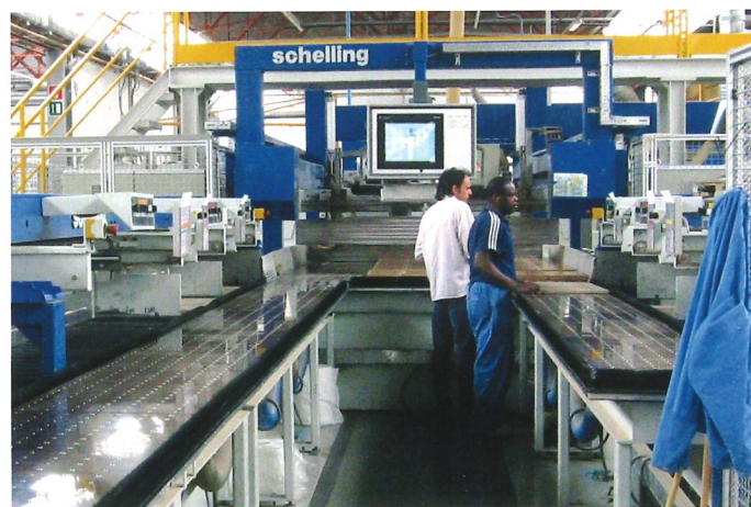
Ručné ukladanie - najjednoduchšia manipulácia s materiálom
