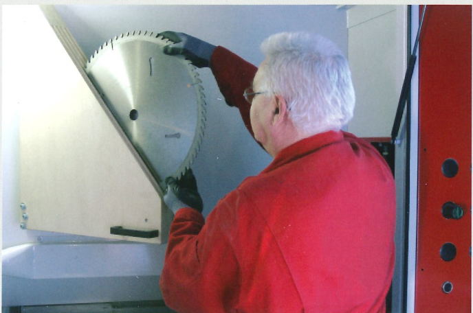
Priečinkov pílových listov - integrovaný do opláštenia stroja
