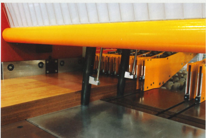
Dvojitý vyrovňávač pásov - najvyššia presnosť uhlov
