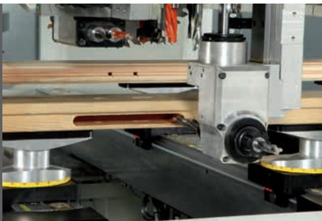
Die SCM Arbeitstische sind mit den gleichen Zubehörteilen ausgestattet und bieten stets eine sichere Werkstückspannung, um auch bei hohen Spanabnahmen eine hervorragende Oberflächenqualität zu erzielen.
