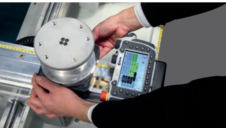
Bei der Version „Pilot“ ist die Positionierung geführt und wird vom Werkstückprogramm überwacht. Magnetische Sensoren erfassen die korrekte Position aller Komponenten und schließen somit alle Kollisionsrisiken aus.
