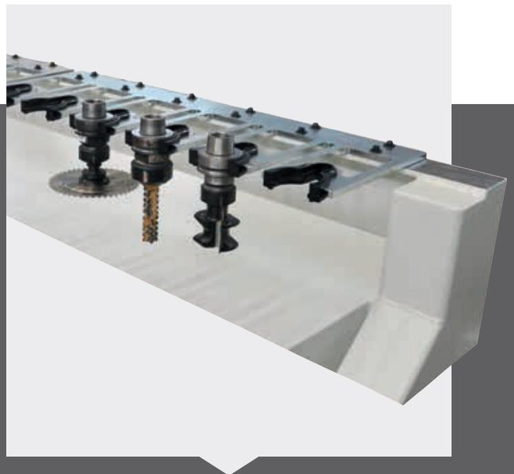
Accord fx verfügt über Lösungen, die sich jeder Produktionsanforderung anpassen, wie „Rapid 12 On Board“ für einen Werkzeugwechsel ohne Zeitverlust und mit der Möglichkeit zur Kombination mit weiteren Zusatzmagazinen wie Rapid 16 oder 24.
