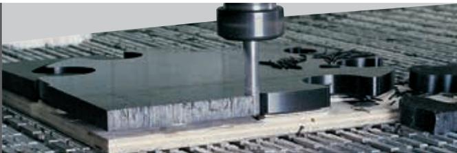
Die direkte Bearbeitung des Maschinentischs garantiert höchste Präzision und dauerhafte hohe Planparallelität dank der hohen Verwindungssteifigkeit. Ideal zur Bearbeitung von Kunststoff, Harz und Leichtlegierungen.
