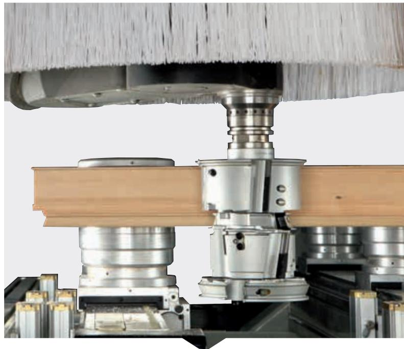
Der Arbeitstisch H145 ist auf eine maximale Bewegungsfreiheit ausgelegt und ermöglicht auch die Verwendung von Werkzeugen mit „Doppelprofil“.
