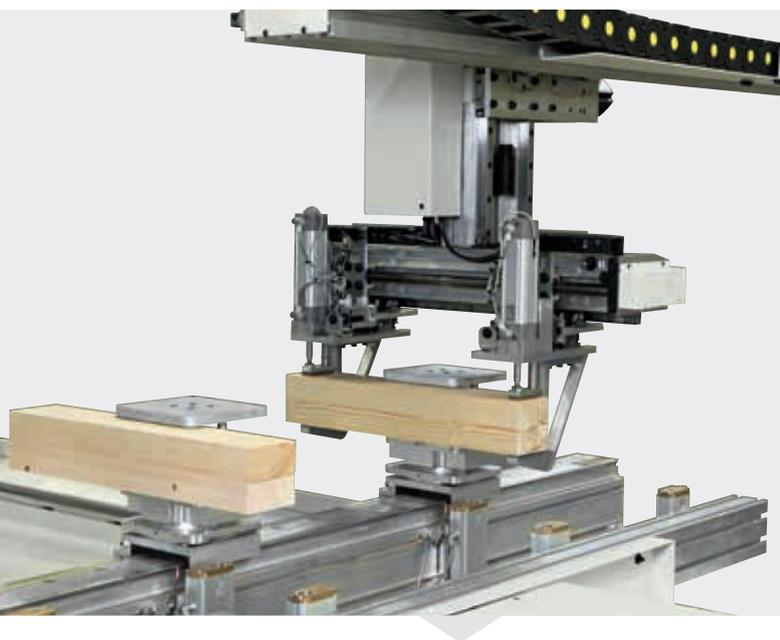
Kürzere Elemente werden automatisch aufgegeben und mit einer einzelnen Klemme aufgespannt.
