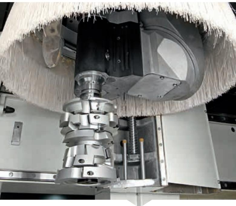
Die SCM-Elektrospindeln, mit HSK 63 E Aufnahme, sind leistungsstark und zuverlässig. Sie erlauben die Verwendung von großen Werkzeugen mit Doppel-Profil. Dies gewährleistet die einfache Profilierung von Werkstücken mit großem Querschnitt.
