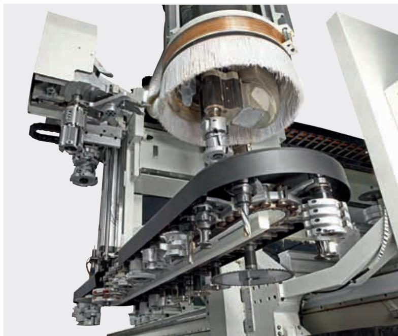
Der Kettenwechsler TRC mit 48 Plätzen für große Werkzeuge oder solche mit Doppelprofil sorgt dafür, dass die Maschine stets für jede Bearbeitung gerüstet ist.
