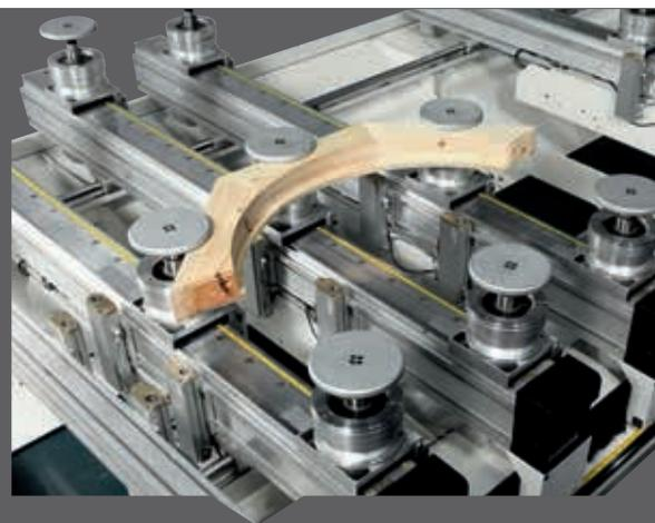
Perfekt zur Vor- und Fertigbearbeitung von Fenstern und Türen. Alle Auflagen sind mit Reinigungsdüsen versehen, die die Späne im Durchlaufbereich sowie im unteren Bereich der Werkstückeinspannung beim Wechsel der Spannzylinder entfernen.
