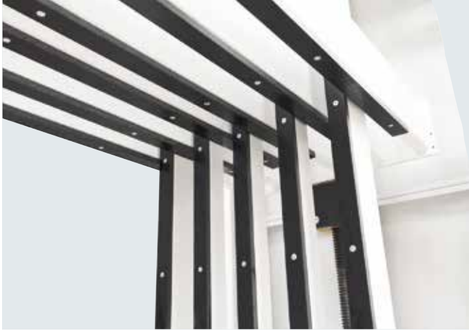
Bessere Qualität durch vollflächige Pressung (Kammsystem).
