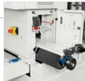
Auswechselbares Bürstenaggregat im Auslauf für eine hohe Arbeitsflexibilität.
