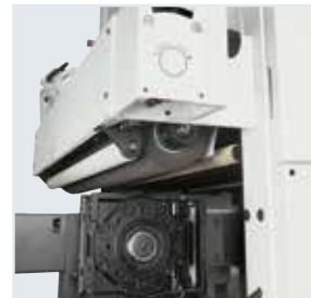
Oszillierendes Satinieraggregat und Strukturieraggregat am Auslauf für einen hochwertigen Endschliff.
