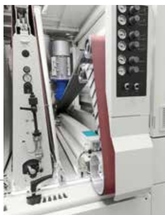
Inneres auswechselbares Queraggregat mit 5000 mm Länge.
