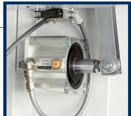
Vorrichtung zur automatischen Teppichzentrierung, für eine längere Lebensdauer des Vorschubteppiches.
