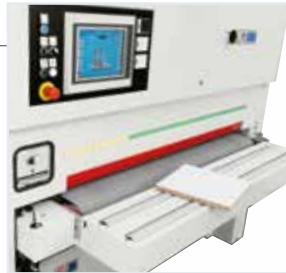
Überwachung der Schleifbandabnutzung zur Reduzierung der Kosten.
