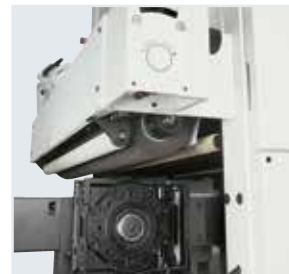
Satinieraggregat und Strukturieraggregat am Auslauf für einen hochwertigen Endschliff.
