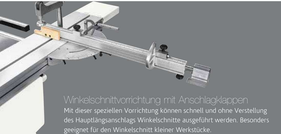
Winkelschnittvorrichtung mit Anschlagklappen
