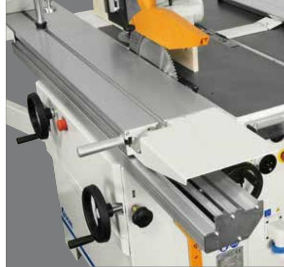
Präzisere und bequemere Schnitte mit der Säge, dank einer völlig stabilen Auflage, die – auch für große Werkstücke – durch den **Schiebeschlitten mit einer Breite von 270 mm** gewährleistet ist.
