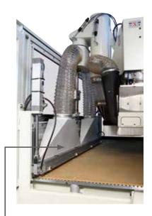
**Null Staub** mit dem oben eingerichtetem Absaugsystem zum Reinigen der Arbeitstisch.
