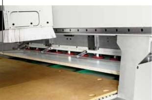
Der **Hubtisch** kann Plattenstapel von bis zu maximal 700 mm Höhe aufnehmen.
