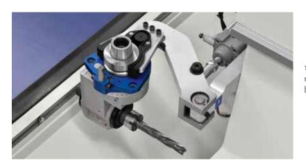
1-Position "**Pick-up**"-Werkzeugwechsler mit pneumatischer Positionierung, am beweglichen Querträger befestigt.
