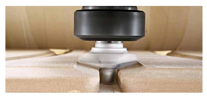
Leistungsfähigkeit und Festigkeit bei der Bearbeitung dank der Bohraggregate mit bis zu 18 unabhängigen Spindeln. Einfache Ausführung von Nuten an den Möbelteilen durch das integrierte Sägeaggregat.
