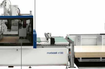
**Präzise und schnelle Positionierung** der Platten auf dem Arbeitstisch durch ein Beladeaggregat mit Saugnäpfen.
