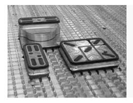
Breite Auswahl an MPS-Sauger und MODULSET um die Werkstücke auf dem Arbeitstisch je nach Bearbeitungstyp zu befestigen.
