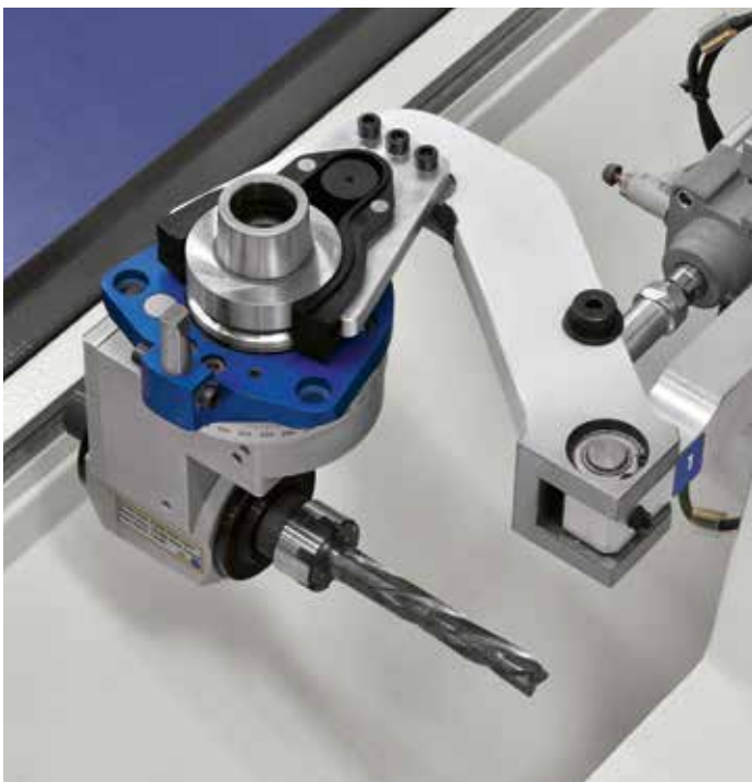
1-Position "Pick-up"-Werkzeugwechsler, am beweglichen Querträger befestigt. Ideale Ausstattung zum Einsatz von Platz raubenden Werkzeugen und Winkelgetrieben.
