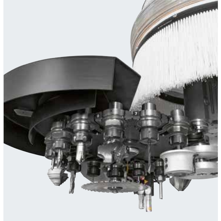
Werkzeuge immer zur Verfügung dank dem hinteren R16 Werkzeugwechslers.
