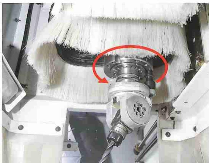
**Asse rotante Vector** per fresature, tagli e forature inclinate utilizzando le testine a rinvio angolare
