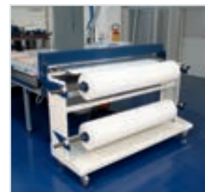
Magazin der PVC Rollen mit manuellem oder pneumatischem Schnitt (Option).
