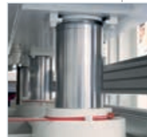
Hydraulikzylinder Der Schaft besteht aus einer sehr dick verchromten geschliffenen Stahllegierung, die Dichtungen sind extrem widerstandsfähig, um eine lange Lebensdauer und eine perfekte Abdichtung zu gewährleisten.
