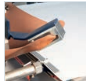
Membran mit Vorrichtung zur Schnellspannung, ermöglicht einen schnellen Wechsel von einem Arbeitszyklus zum anderen.
