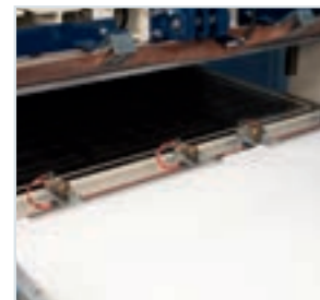
Der bewegliche Tisch unten ist gefräst um einen Vakuumkreislauf zu schaffen.
