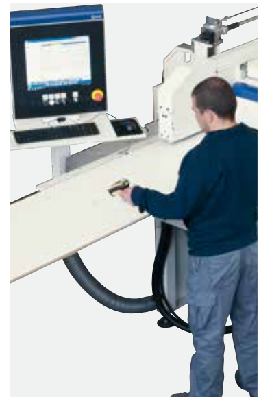
EINFACHE EINSTELLUNG VON FORTSCHRITTLICHER TECHNOLOGIE Automatische Programmierung über Barcode
